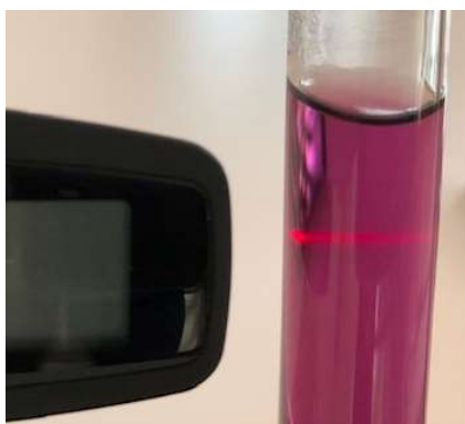
Obr. 14 Tyndallov efekt pri prechode svetla koloidným roztokom nanočastíc striebra
