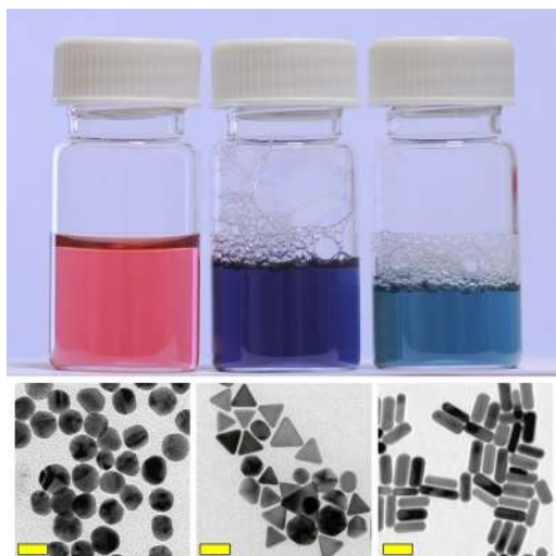
Obr. 39 Koloidné roztoky Au spolu so snímkami z elektrónového mikroskopu (mierka = 30 nm) [4]
