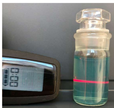
Obr. 8 Tyndallov efekt pri prechode svetla koloidným roztokom nanočastíc striebra
